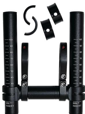
長距離ライドでポジションを上げたいときに最適なミニバーです。通常130mmのTRI-MINI BARを30mm伸ばし160mmに伸ばすことで使い勝手がさらに良くなっています。ハンドルの各サイズにも対応できるようにシムも付属されています。シムは25.4φ用、26.0φ用で、シムなしの場合は31.8φ用となっています。
